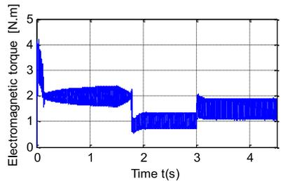
(d) Torque response of PV pumping system
