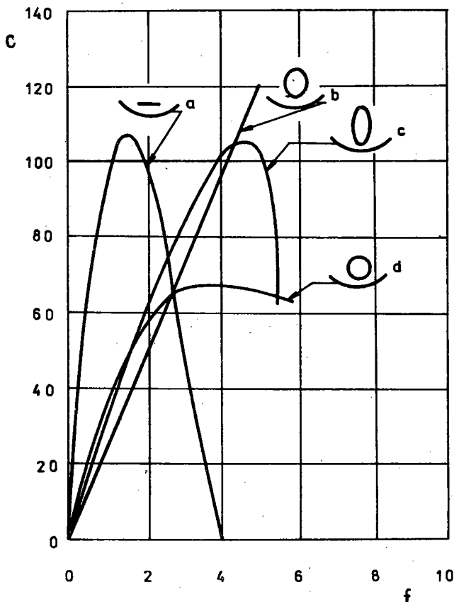
Rys.32. Koncentracja promieniowania dla koncentratora parabolicznego z absorberami o różnych kształtach [31]: a) absorber płaski, b) absorber paraboliczny (optymalny), c) absorber eliptyczny, d) absorber kołowy
