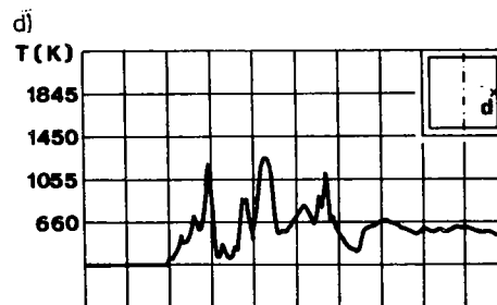
Rys.5. Rozkład temperatury w płomieniu pyłowo-powietrznym, w różnych odległościach od ścianki kanału (pył węgla brunatnego): a) w osi kanału, b) 25 mm od ścianki, c) 6 mm od ścianki, d) 2 mm od ścianki
