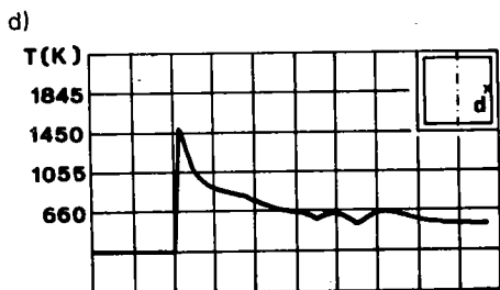
Rys.2. Rozkład temperatury w płomieniu gazowo-powietrznym w różnych odległościach od ścianki kanału. a) w osi kanału, b) 25 mm od ścianki, c) 6 mm od ścianki, d) 2 mm od ścianki
